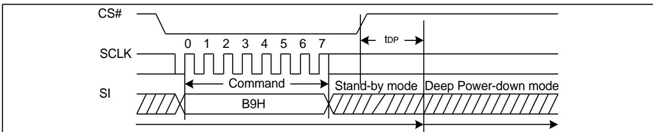
**Figure22a. Deep Power-Down Sequence Diagram (QPI)**
