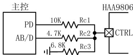
如上电路设置所示,如果主控的 IO 口为 3.3V,借助 PD 及 AB/D 两个 IO 口以及分压线路实现各种模式切换,当 PD 口及 AB/D 口同时为低电平时,功放工作在关断状态;当 PD 口为高电平,AB/D 口悬空(高阻状态),Rc1 和 Rc3 构成分压,此时 CTRL 引脚的电平  $1.33V (V_{CTRL} = V_{IO} * Rc3 / (Rc1 + Rc3))$  功放工作在 AB 类模式;当 PD 口悬空(高阻状态),AB/D 口为高电平时,Rc2 和 Rc3 构成分压,此时 CTRL 引脚的电平为 1.95V ( $V_{CTRL} = V_{IO} * Rc3 / (Rc2 + Rc3)$ ) 此时工作在防破音模式;此外,CTRL 还具备一线脉冲切换 AB 类、D 类工作模式以及切换 2 种 AGC 防破音的功能。当主控 IO 控制口比较少时,用户可用一线脉冲切换的方式实现 AB/D 等工作模式的切换控制。
