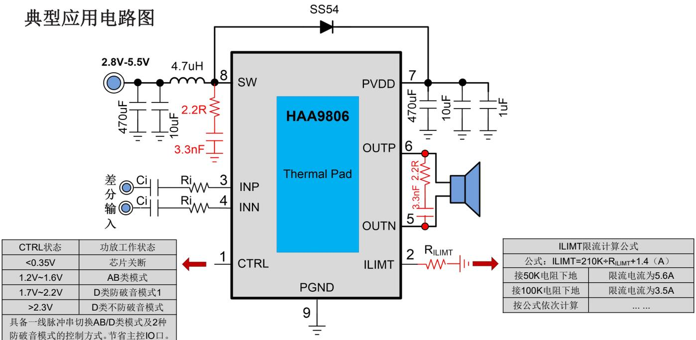
**BOOST 升压,带 2 种防破音功能,AB 类/D 类切换,10W 单声道音频功率放大器**
